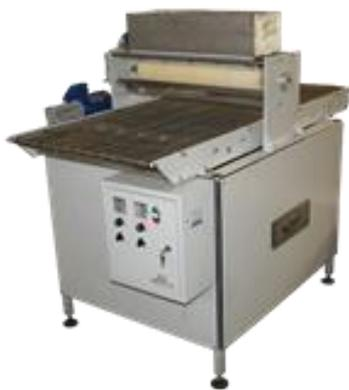
**МП-600(900)** – машина посыпки, предназначенная для декорирования верхней поверхности кондитерских изделий (сахарное печенье, крекер, сушка, кондитерские пласты и т.д.) сыпучей фракцией (сахар, мак, кунжут и т.д.). Машина используется в составе поточных линий формовки и выпечки печенья.
